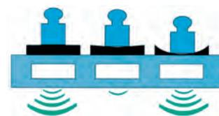
**Comprimibilità:** da non confondersi con la resistenza a compressione, indica il sovraccarico a cui il materiale isolante può essere sottoposto senza modificare la sua rigidità dinamica. Il valore deve essere determinato secondo la norma UNI EN 12431. Se il materiale rientra in un livello troppo basso di comprimibilità difficilmente manterrà le caratteristiche nel tempo. La norma UNI EN 13163 classifica i materiali secondo la tabella a sinistra.
