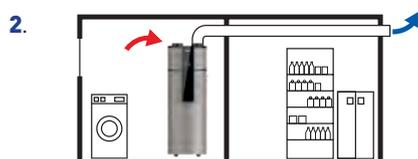
**Installazione con aspirazione d'aria interna e uscita dell'aria verso l'esterno.** La produzione di ACS avviene sfruttando l'aria presente nel locale d'installazione, che poi viene espulsa all'esterno tramite canalizzazione.
