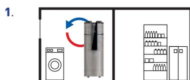
**Installazione ad aria ricircolata con ingresso e uscita dell'aria che avvengono nel locale d'installazione.** La produzione di ACS avviene sfruttando l'aria presente in ambiente e contestualmente sottraendo a esso calore e umidità, raffreddandolo. È suggerita l'installazione di un setto divisorio che eviti il ricircolo dell'aria nelle immediate vicinanze della bocchetta di aspirazione.
