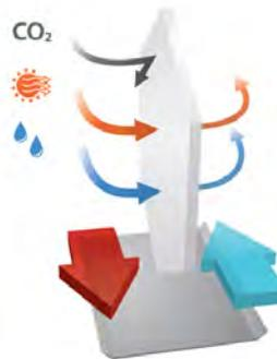
**FRESHBOX 100 ERV WIFI** è equipaggiato con uno scambiatore a piastre a controcorrente dotato di una membrana entalpica. Grazie alla membrana entalpica si ottiene un trasferimento, sia di temperatura che di umidità, sia nella stagione fredda che in quella calda. Pertanto non vi è formazione di condensa.
